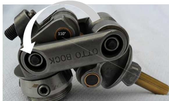
Figura 25. Flexión máxima de rodilla policéntrica, creación propia.
