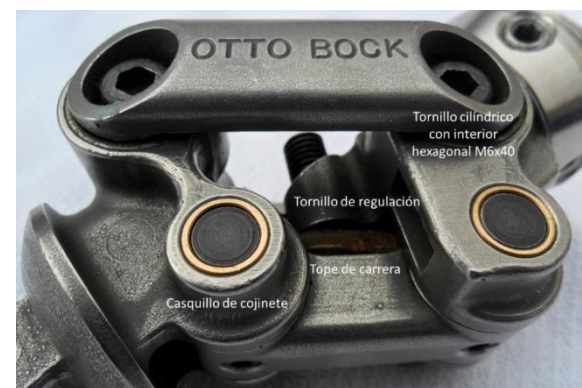
Figura 24. Vista lateral derecha de la rodilla policéntrica, Creación propia.
